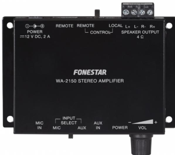
Компактный HiFi стереоусилитель, 2x15 Вт с микрофонным и линейным входом. Выход для дистанционного управления для удаленной регулировки звука, выносной регулятор подключается по кабелю UTP Cat 5е. Специально разработан для аудиоинсталляций. Очень надежный усилитель с высококачественным звуком. Компактный и крепкий корпус.
